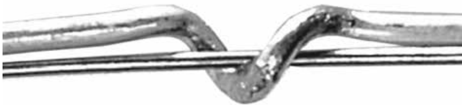
Figura 19. Fusión parcial de un eslabón fusible tipo K, de corriente nominal igual a 50A rcm
